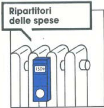
Una volta installato il sistema di termoregolazione prescelto, per completare l'impianto bisogna installare nel proprio appartamento gli strumenti di misura del calore.
