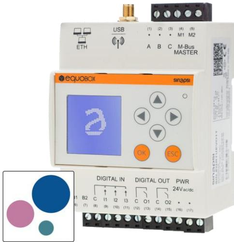
EQUOBOX RTUEVO1T (SIN.EQRTUEVO1T) è un datalogger per l'acquisizione di dati provenienti dai SIN.EQRPT868XT, che, attraverso la rete MESH, raccolgono informazioni da dispositivi che utilizzano il protocollo M-Bus cavo e wireless quali contatori, ripartitori di consumo e sonde. Gestisce fino a 3000 contatori (2500 wireless + 500 cavo) consentendo di memorizzare le letture quotidiane per 10 anni.
